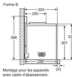
Montage pour les appareils avec cadre d'abaissement.
