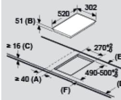
A: Distance minimum entre la découpe de la plaque de cuisson et le mur.
