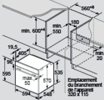
Emplacement du branchement de l'appareil 320 x 115
