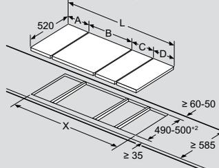
Si deux éléments ou plus sont installés l'un à côté de l'autre, un ou plusieurs kits d'installation sont nécessaires (2 éléments = 1 kit d'installation, 3 éléments = 2 kits d'installation, etc.).
