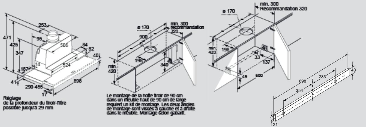
Réglage de la profondeur du tiroir-filtre possible jusqu'à 29 mm
