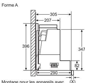
Montage pour les appareils avec cadre d'abaissement.
