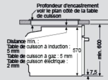
Profondeur d'encastrement voir le plan côté de la table de cuisson
