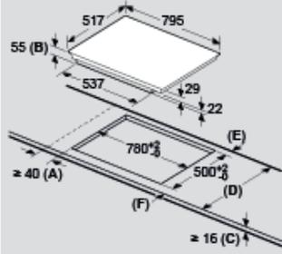
**A:** Distance minimum entre la découpe de la plaque de cuisson et le mur.
