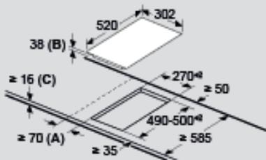
A: Distance minimum entre la découpe de la plaque de cuisson et le mur.
