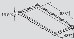
Ne pas monter directement dans la plaque de plâtre ou autres matériaux légers similaires du plafond suspendu. Une structure appropriée est nécessaire, solidement fixée dans le plafond en béton.
