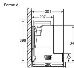
Montage pour les appareils avec (X) cadre d'abaissement. Profondeur du meuble conforme au tableau des combinaisons
