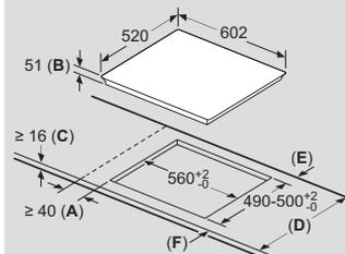
**A:** Distance minimum entre la plaque de cuisson et le mur
