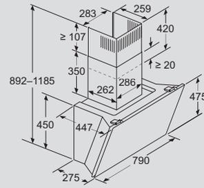
Appareil en mode circulation d'air sans conduit
